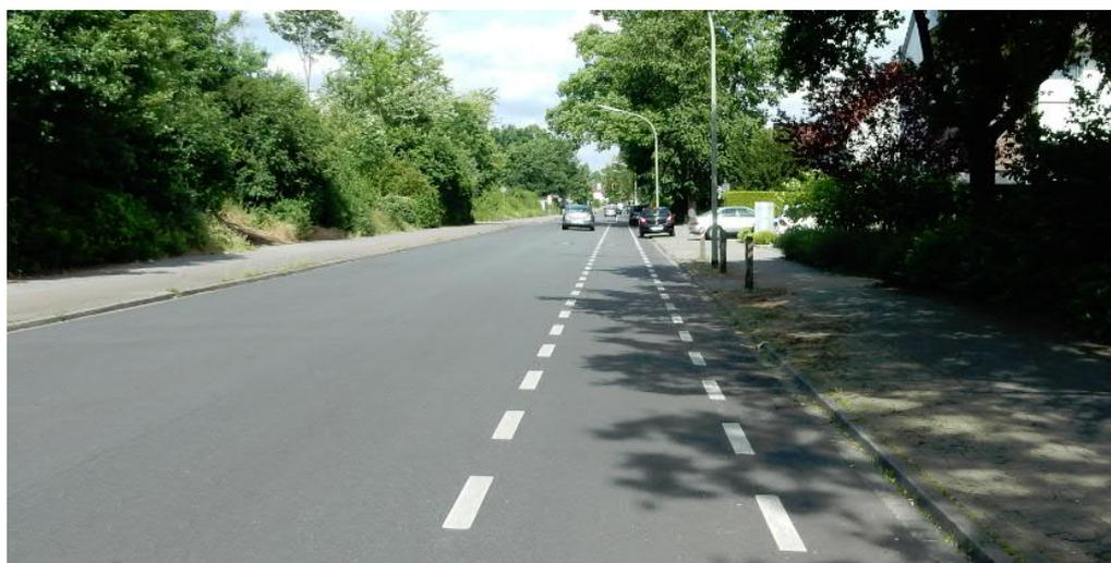
Abb. 23 Einseitige Markierung von Schutzstreifen (Osnabrück)
