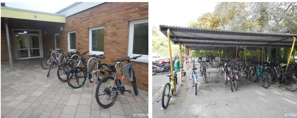
Abb. 58 Rahmenhalter an KGS Gronau (links) und Vorderradhalter am Gymnasium Alfeld (rechts)
